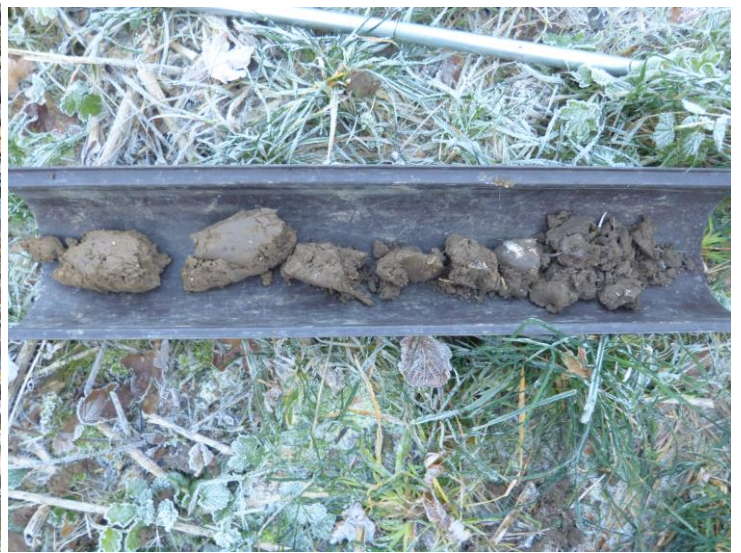
Figure 9 : profil de sol du sondage S2.
